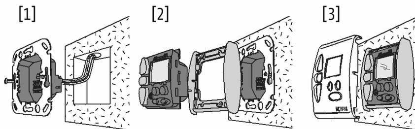
Řídicí jednotka **Chronis Smart UNO** je určena pro montáž do instalační krabice pod omítku o  $\varnothing 60$  mm anebo do odpovídající krabice na omítku.
